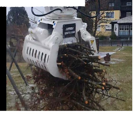
SORTIERGREIFER: Sie ermöglichen den Abriss von Ziegel- und Holzkonstruktionen und somit die Trennung des beim Abriss gewonnenen Materials, um das Recycling zu fördern. Die Sortiergreifer von ITR bestehen aus besonders widerstandsfähigem, verschleißfestem Stahl und sind mit einem hydraulischen Zylinder versehen, der mit einem Kolbensystem synchronisiert ist, um homogene Bewegungen zu begünstigen.
